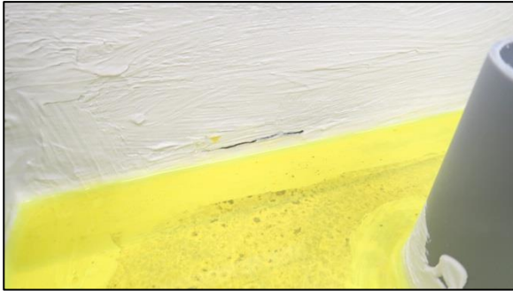
Figur 9. Vattennivån hos den tätade prototypen 2.1 efter 90 dagars exponering.
