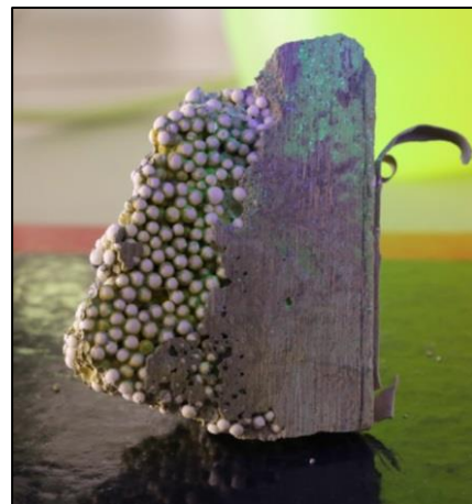
Figur 7. Betongbit exponerad för pyraninfärgat vatten för utvärdering diffusionsbenägenheten hos vattnet in i betongen.
