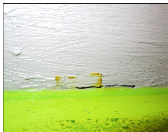
Figur 8. Prototyp 2.1 tätad med plastfolie och plastfilm (vänster bild) för att studera effekten av avdunstning. Vattennivån noterades innan prototypen tätades (höger bild).
