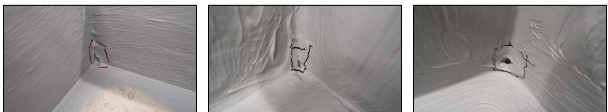
Figur 2. Defekter i tätskikten vid och efter målning på prototyperna.
