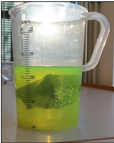
Figur 7. Betongbit exponerad för pyraninfärgat vatten för utvärdering diffusionsbenägenheten hos vattnet in i betongen.
